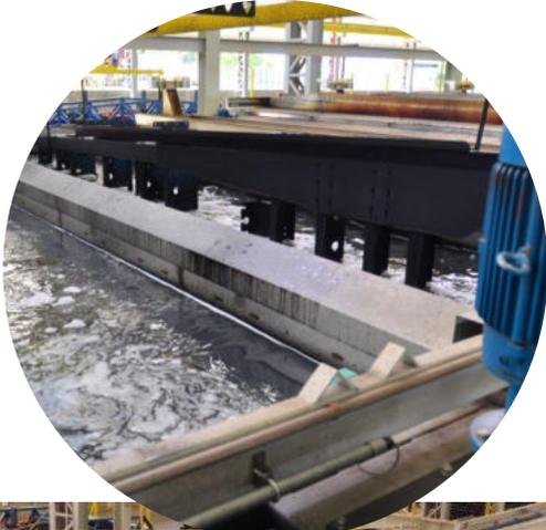
LIMPEZA COM DESENGRAXANTE QUÍMICO E FOSFATIZAÇÃO, APLICAÇÃO DE FUNDO ANTICORROSIVO. ACABAMENTO PINTURA ELETROSTÁTICA A PÓ, TINTA ECOLÓGICA SEM SOLVENTE, COM ALTO ACABAMENTO, UNIFORMIDADE E RESISTÊNCIA.
