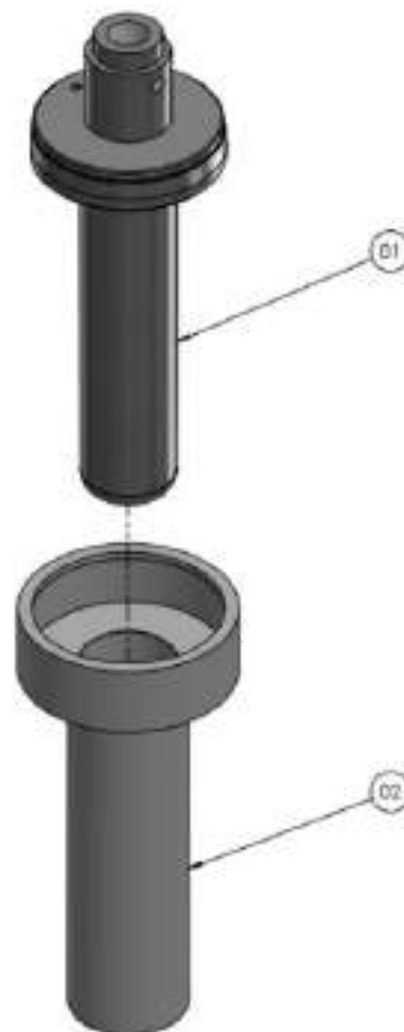
Ilustração 8 – Fixação e retirada da empunhadreira
