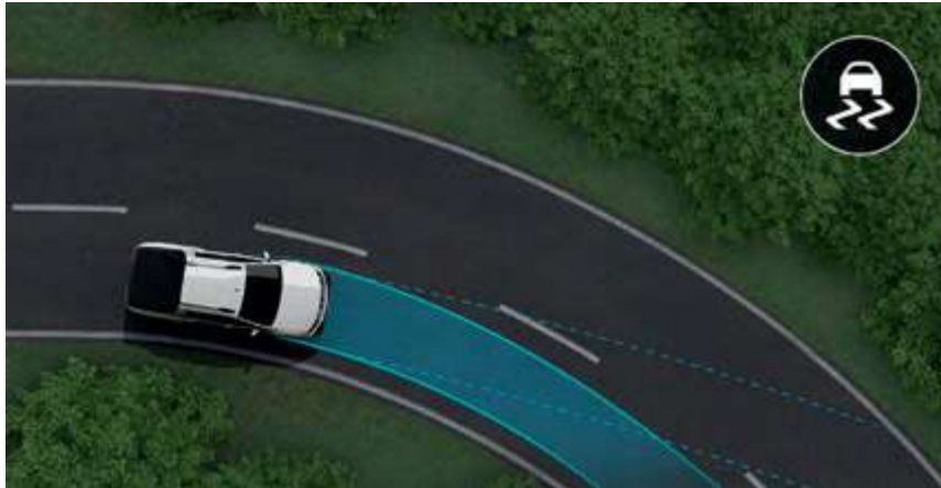
controle de estabilidade Corrige automaticamente a trajetória do seu carro para evitar derrapagens perigosas.
